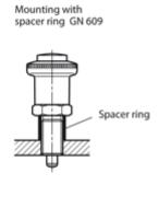
Axial load capacity N = 200d1 = 10 d2 = M16x1,5 d3 = 28 e = 21.9
